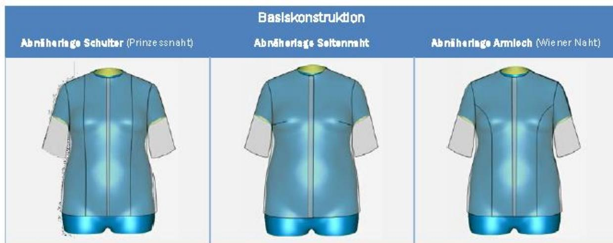
Abbildung 2: Basiskonstruktionen mit unterschiedlichen Abnäherpositionen
